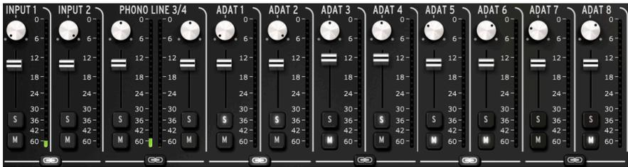
Ist der Digitaleingang auf ADAT gestellt und eine der beiden niedrigsten Samplerraten gewählt, werden neben den vier Analogeingängen auch acht ADAT-Kanäle angezeigt.
