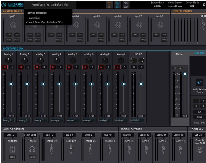
In diesem Fenster können Sie zwischen den Geräten umschalten, wenn mehr als ein AudioFuse-Produkt an denselben Computer angeschlossen ist. Auf diese Weise können Sie auswählen, welches Gerät Sie mit Hilfe des AFCC editieren möchten.
