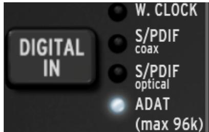
Während Sie mit dem Digital In-Taster durch die Optionen schalten, leuchtet eine LED, um die aktuelle Auswahl anzuzeigen.
