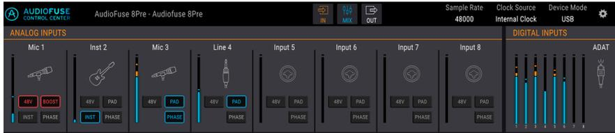
Der Eingangsbereich unterhalb der Menüleiste erstreckt sich über die gesamte Breite des AFCC-Fensters. Er bietet eine virtuelle Darstellung der Frontseite des AudioFuse 8Pre sowie Anzeigen, die das an den ADAT-Eingängen eingehende Signal darstellen.
