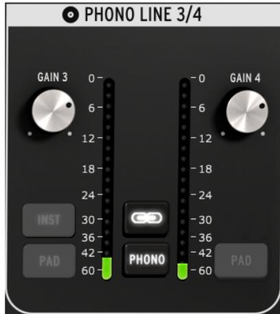
Wenn Sie den Link-Taster aktivieren, springen die Gain-Regler auf den niedrigeren der beiden Werte. Anschließend können Sie beide Werte parallel einstellen.
