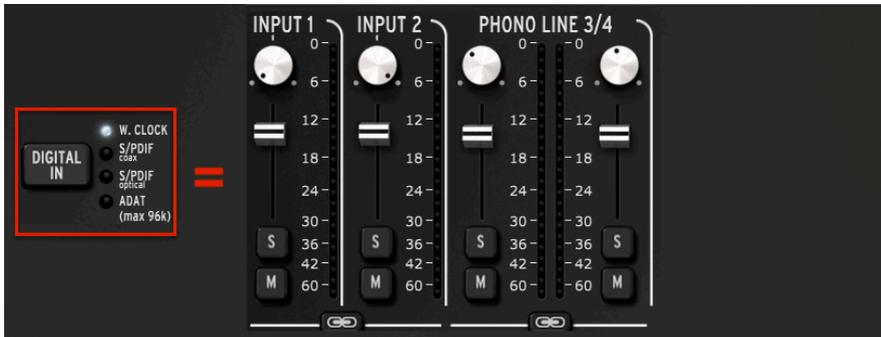
Diese wird für alle Samplerraten angezeigt, wenn Word Clock für den Digital In ausgewählt ist. Das ist die grundlegendste Konfiguration mit nur vier genutzten Audiokanälen.
