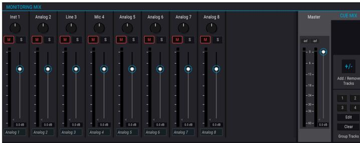
Wenn Sie diese Grafik mit der [weiter oben in diesem Abschnitt \[p.39\]](#) vergleichen, werden Sie feststellen, dass etwas fehlt: die USB-Eingangskanäle. Hier der Grund dafür: Wenn sich das AudioFuse 8Pre im ADAT-Modus befindet, wird es als Analog-Digital-Wandler verwendet, so dass der Mix keine eingehenden USB-Kanäle enthält. Wenn sich das AudioFuse 8Pre im USB-Modus befindet, können Sie dem Cue Mix alle drei Eingangskanal-Arten hinzufügen: Analog, ADAT und USB.
