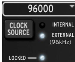
Stellen Sie anschließend im Menü Sample Rate das AudioFuse auf die gleiche Samplerate wie das Master-Gerät ein. Wenn die Locked-LED wie in der Abbildung oben leuchtet, sind beide Geräte perfekt synchronisiert.
