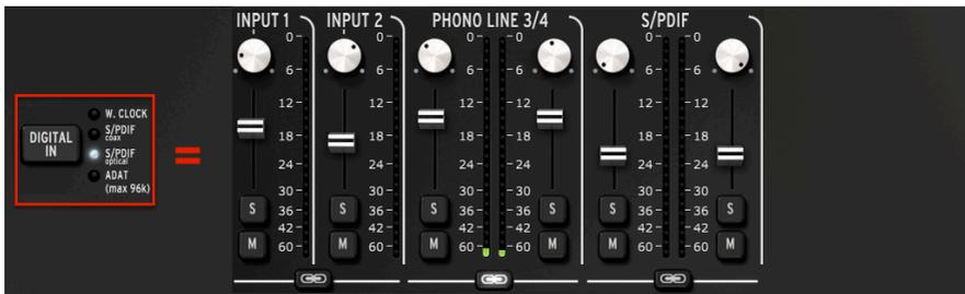
Die Anzahl der Eingangskanäle erweitert sich um ein Kanalpaar, wenn Sie für den Digitaleingang S/PDIF wählen (koaxial oder optisch). Hierbei stehen alle Samplerraten (44100 bis 192000) zur Verfügung.
