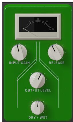
リミッターはコンプレッサーの用途限定バージョンとも言えるもので、設定したレベル以上に音量が上がらないように"天井"を設けるエフェクトです。入力音のダイナミックレンジが広く、信号がクリップすることにより生じる音の歪みやノイズなどを防ぎたい場合に特に便利です。
