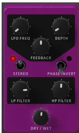
フランジャーは入力音に短いディレイをかけ、その信号をLFOなどでモジュレーションをかけるエフェクトです。動作原理はコーラスとほぼ同様ですが、コーラスのディレイタイムが比較的長めなのに対し、フランジャーは極めて短いディレイタイムで動作し、コムフィルター効果が刻々と変化していくタイプのエフェクトです。
