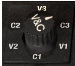
このノブで、上下鍵盤それぞれの鍵盤のビブラートスイッチがオンの場合にかかるビブラート（3タイプ）とコーラス（3タイプ）のタイプを選択します。ノブのポジションはそれぞれのエフェクトの深さを表しています。C1が軽めのコーラスで、C3はより深いコーラスです。同様に、V1は軽めのビブラートでV3はより深いビブラートです。つまり、1→3へ順に効果が深くなっていきます。
