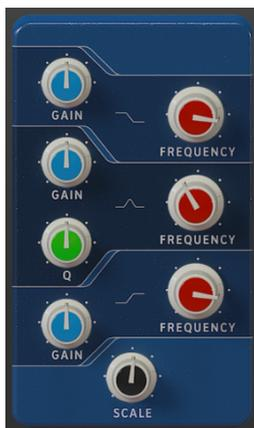
イコライザーは複数のフィルターが入ったユニットで、各フィルターは特定の周波数帯域をそれぞれ担当し、その帯域をブースト/カットすることで入力音の全体的な音質を調節します。控えめに使った音質補正から、特定帯域を強調してミックスでのヌケを良くするなど、色々な使い方ができます。
