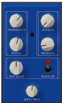
コンプレッサーは、スレッシュホールドレベルを超えた入力信号の音量を抑え、最大音量と最小音量との差をスムーズにするエフェクトです。過大なレベルを抑えることで、入力音の全体音量を上げることができ、それにより音が小さい部分も相対的に音量を大きくできます。コンプレッサーは、ミックスによく馴染む聴きやすくバランスの取れた音にするための非常に便利なツールです。
