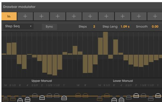
ステップシーケンサーではステップごとにモジュレーションの深さを入力でき、よりリズム的なモジュレーションに適しています。
