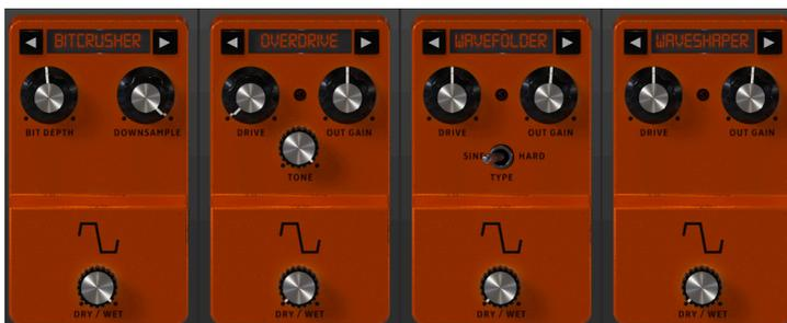
このペダルは、マイルドなドライブやクランチ、グリットから激しいディストーション、ファズ、ビットクラッシャーまで、4種類の歪み系エフェクトを内蔵しています。
