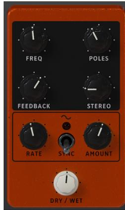
フェイザーは、1960年代から70年代にかけて人気だったサイケデリックなスイープエフェクトで、音に動きや回転感を付けるエフェクトです。入力音を分岐し、片方に多段式のオールパスフィルターを通して周波数スペクトラム上にピーク (山) とディップ (谷) を付け、原音にミックスします。この時、オールパスフィルターにモジュレーションをかけると、位相が干渉する周波数帯域が変化して、独特の"シュワシュワした"サウンドになります。
