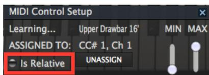
Is Relativeは、プリセットを切り替えた時に、MIDIコントローラーの同じノブ等を別々のパラメーターのコントロールに使用している場合に便利です。例えばIs Relativeがオフの場合、MIDIコントローラーのノブを回すと、それに対応しているパラメーターの値がノブの向きに合うように急激にジャンプして変化します。Is Relativeがオンの場合、ノブを回すと、そのパラメーターのその時の値からジャンプせずにノブを回した方向へ変化します。但し、Is Relative機能は、お使いのMIDIコントローラーがレラティブモードをサポートしている必要がありますのでご注意ください。レラティブモードをサポートしているかどうかは、お使いのMIDIコントローラーの説明書等をご参照ください。
