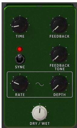
アナログディレイは、先述のディレイとは音の傾向が異なるもう1つのタイプのディレイです。基本動作は先述のディレイと同様、入力音を録音して少し後から再生し、フィードバック回路でディレイ音を再び入力するというものです。
