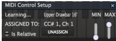
ポップアップ画面にはMinとMaxのスライダーもあり、パラメーターの変化幅をデフォルトの0%~100%よりも狭く設定することができます。例えばアンプのマスターボリュームをMIDIコントローラーから30%~90%の範囲でコントロールしたいとします。この場合、Minを0.30、Maxを0.90に設定すると、MIDIコントローラーのノブ等をどう操作してもアンプのマスターボリュームは30%以下にも90%以上にもなりません。このように、例えばライブ中の誤操作などで音量が急に過大になったり、極端に小さくなったりすることを防止でき、非常に便利です。
