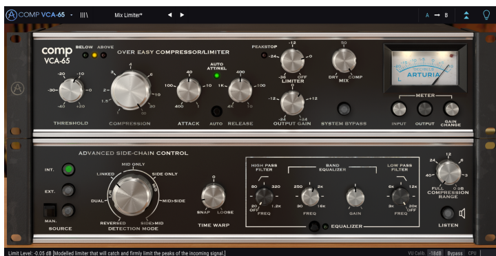
Le Comp VCA-65 paramétré pour fonctionner comme un Limiteur
