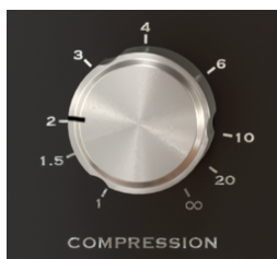
Contrôle Compression du Comp VCA-65 réglé à un taux de 2:1
