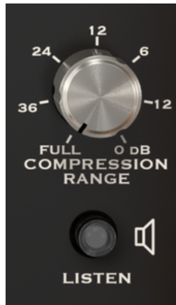
Contrôles Full Compression Range et Listen du Comp VCA-65
