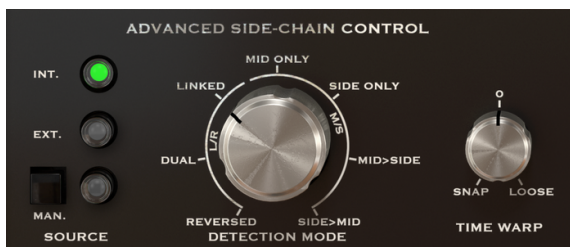
Sección de control avanzado de encadenamiento lateral Comp VCA-65 (como aparece en pistas estéreo)
