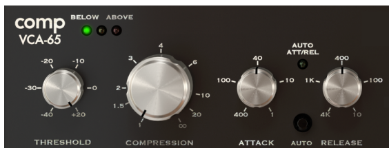
Los controles principales del compresor VCA
