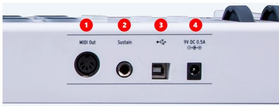
1. **La sortie MIDI** La prise de sortie MIDI Out du KeyLab Essential peut servir à envoyer des informations MIDI à vos modules et synthés non intégrés lorsqu'ils sont alimentés par un bloc d'alimentation optionnel, plutôt qu'en USB.
