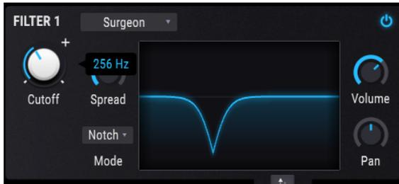
サージョンフィルターは64dB/octという極めて急峻な特性のフィルターで、各種モードが選択できます。
