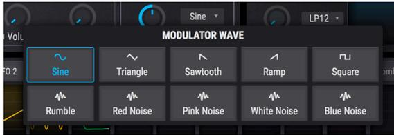
モジュレーターオシレーターの波形を10種類から選択します。5種類のシンプルな波形と、5種類のノイズソースの合計10種類です。
