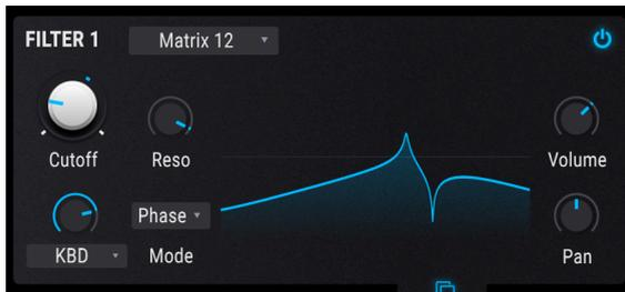
各フィルターにはそのセッティングをグラフィック表示するウィンドウがあります。例えばカットオフフリケンシーを調節すると、その操作に応じた反応がグラフィカルに表示されます。
