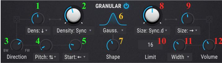
このセクションは、サンプルエンジンをグラニューラーシンセサイザーとして使用するためのセクションです。このセクションがオフの場合、サンプルエンジンは一般的なサンプルプレイバックエンジンとして動作します。
