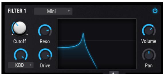
1960年代から70年代にかけて音楽界をシンセサイザー旋風に巻き込んだアイコン的な24dB/octラダーフィルターは、間違いなく最も有名なシンセフィルターでしょう。そのフィルターを再現したのがこのMiniフィルターです。
