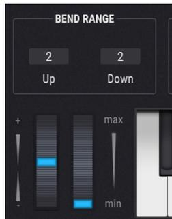
ヴァーチャル・キーボードの左側にはピッチとModホイールがあります。この2つはマウスで上下にドラッグして使用します。ホイールを操作するとアサインされている機能が動作します。この2つのホイールはMIDIコントローラー (MIDI CC) に反応します。
