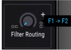
フィルター1と2はシリーズ接続にすることができます。これはフィルター1の出力がダイレクトにフィルター2に入る接続法です。入力信号を極めて精密にフィルタリングできます。
