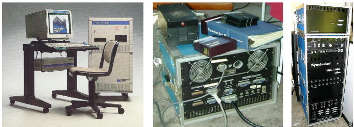
Procesador del Synclavier II con 5.25" Floppy
