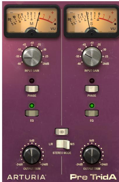
*La sección de preamplificador TridA configurada para trabajar en modo M/S. Observa que el interruptor "Stereo Link" está desactivado y el interruptor de modo estéreo en la posición M/S.*
