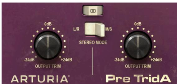
*Perillas TrimA de salida de doble canal y los interruptores para controlar el comportamiento de doble canal (enlace estéreo y modo estéreo)*
