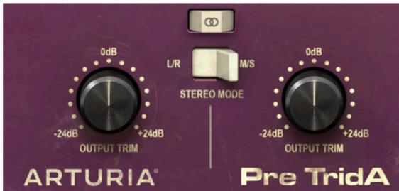
*La sección inferior derecha del panel de control TridA, que muestra los mandos "Output Trim" y encima de ellos, los dos interruptores que controlan el comportamiento del plug-in en canal dual: el "Stereo Mode" y el "Stereo Link".*
