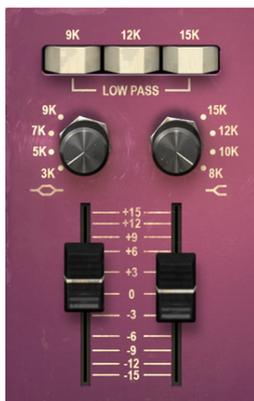
*Las bandas superiores del EQ de un solo canal de TridA (High Shelf y High Midrange Bell), y los tres interruptores del filtro pasa bajos en la parte superior*
