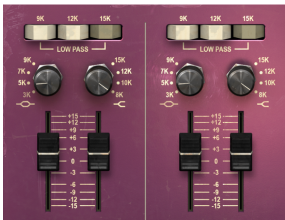
Les bandes supérieures de l'égaliseur en configuration Double Channel du TridA (High Shelf et High Midrange Bell), et les trois interrupteurs de Filtre passe-bas en haut
