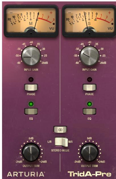
*M/Sモードで動作するように設定されたTridAプリアンプセクション。ステレオリンク・スイッチがオフになり、ステレオモード・スイッチがM/Sを指定しています。*
