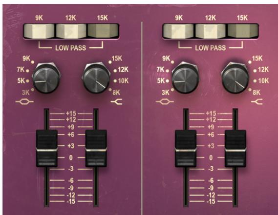
TridAダブルチャンネルEQの高域（ハイシェルフとハイミッドレンジ・ベル）と3つのローパスフィルター・スイッチ
