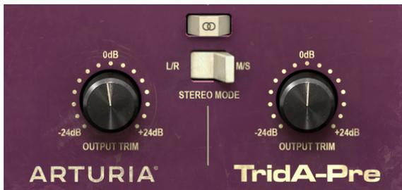
TridAコントロールパネル右下のセクションにはアウトブットリム・ノブがあり、上にはダブルチャンネルのプラグイン動作をコントロールする2つのスイッチ“ステレオモード”と“ステレオリンク”があります。
