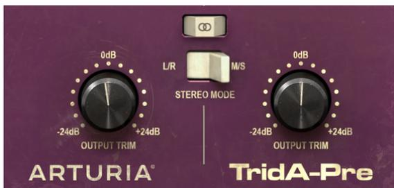
TridAダブルチャンネルのアウトブットリム・ノブとスイッチを使用してダブルチャンネルの動作（ステレオリンクとステレオモード）をコントロール
