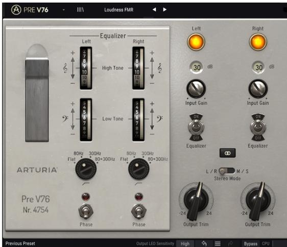
*Pre V76 configurado para agregar algo de "volumen" al sonido. El filtro pasa altos está ajustado para cortar frecuencias por debajo de 80Hz*
