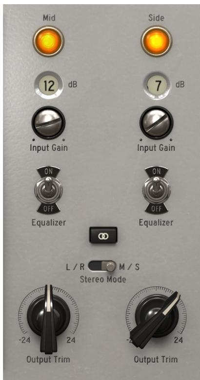
*PreAmp y salida de doble canal del Pre V76. Observa los interruptores de enlace estéreo y el modo estéreo, justo encima de los controles Output Trim y las lámparas de salida que brillan en la parte superior.*
