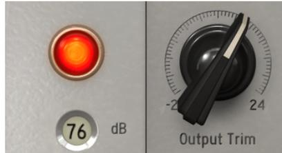
*Lámpara de salida brillante de un solo canal (indicando recorte analógico) y la perilla de ajuste de salida*
