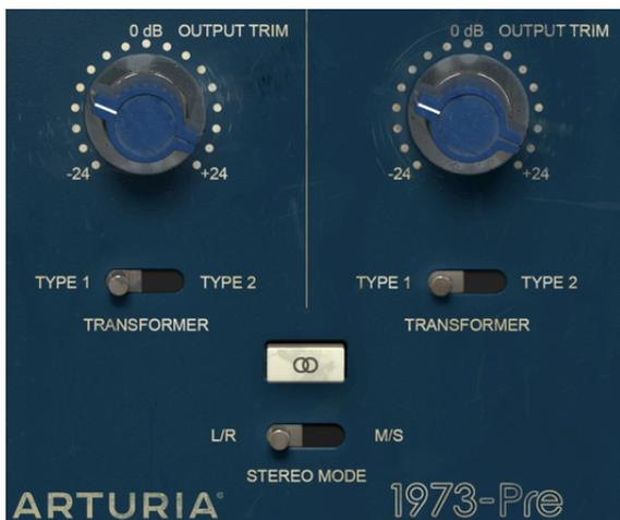
*Salida de doble canal del 1973-pre. Ten en cuenta que, aunque los interruptores de tipo de transformador se colocan debajo de las perillas de ajuste de salida, afectan a la señal justo después de que ingresa en el plug-in, por lo tanto, la selección de tipo de transformador tendrá una influencia sutil pero efectiva sobre el tipo de saturación inducida y distorsión armónica.*
