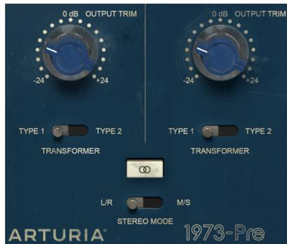
Con estos dos conmutadores, podemos elegir entre los tres modos en los que funciona el plug-in cuando está en la configuración de canal Dual: Stereo, Mid / Side o Dual Mono.
