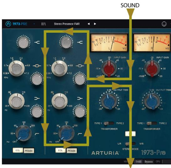
El interruptor de Transformador a la derecha, que nos permite cambiar el tipo de transformador en uso, tendrá un ligero impacto sobre el tipo de saturación inducida y la distorsión armónica producida por el plug-in.
