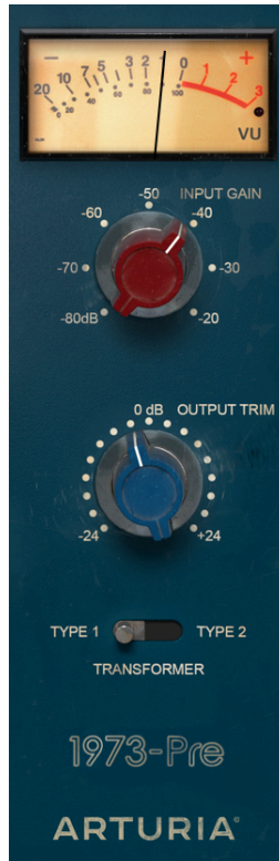
Préampli et Sortie en configuration Single Channel du 1973-Pre
