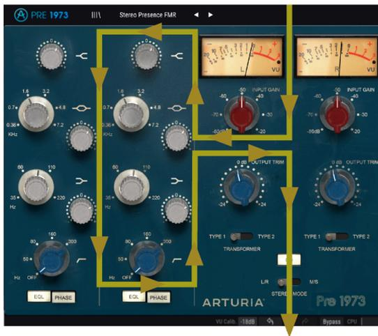
El interruptor de Transformador a la derecha, que nos permite cambiar el tipo de transformador en uso, tendrá un ligero impacto sobre el tipo de saturación inducida y la distorsión armónica producida por el plug-in.
