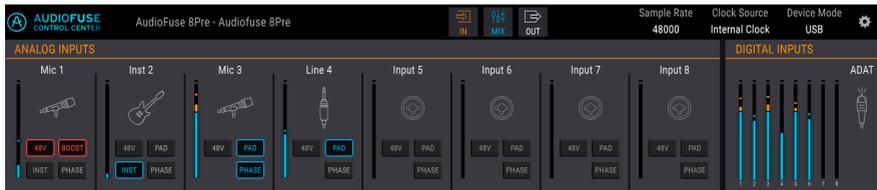
La zone des entrées couvre la largeur de la fenêtre de l'AFCC, sous la barre de Menu. Elle inclut la représentation virtuelle de ce qui se produit sur le panneau frontal de l'AudioFuse 8Pre, avec les indicateurs qui affichent le signal arrivant aux Entrées ADAT.
