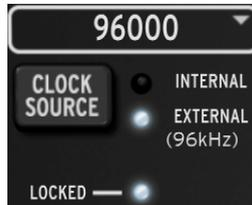
Ensuite, servez-vous du menu Sample Rate pour régler l'AudioFuse à la même fréquence d'échantillonnage que l'appareil maître.
