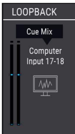
La partie Loopback est visible uniquement quand l'AudioFuse 8Pre est en mode USB. Elle fournit deux canaux d'entrée supplémentaires mais qui sont inaccessibles depuis les panneaux frontal et arrière de l'AudioFuse 8Pre : canaux d'entrée 17 et 18. Ils sont connectés à un flux d'enregistrement USB dédié, afin que la sortie d'une autre application puisse être directement enregistrée par un DAW.
