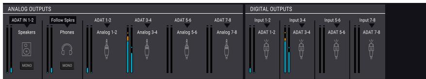
Les sources d'entrée pour les Speakers et Phones peuvent être sélectionnées, et offrent les mêmes options qu'en mode USB. Le tableau suivant montre les options :
