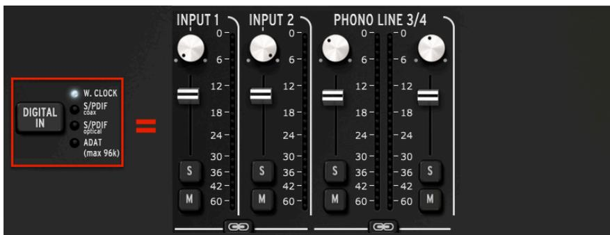
Voilà ce que vous verrez pour toutes les fréquences d'échantillonnage quand Word Clock est sélectionnée en tant qu'entrée numérique (Digital In). Il s'agit de la configuration la plus basique, avec quatre canaux audio utilisés seulement.
