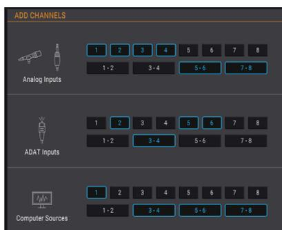
Elle comporte toutes les sources d'entrée incluses dans le Cue Mix. Vous pouvez sélectionner des sources individuelles en cliquant sur un chiffre, ou sélectionner des sources stéréo en cliquant sur l'un des boutons qui contiennent deux chiffres. À mesure que vous cliquez sur chaque bouton, un canal sera ajouté ou retiré de l'affichage des canaux dans la partie Monitoring Mix, qui reste visible en arrière-plan.
