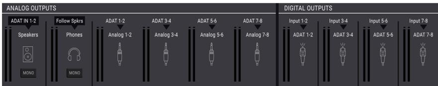
En mode ADAT, la majorité des routages d'entrées/de sorties sont fixes. Par exemple, les Analog Inputs 1-2 sont toujours routés aux ADAT Outputs 1-2, et les ADAT Inputs 1-2 sont routés aux Analog Outputs 1-2, etc.
