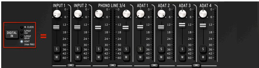
Les fréquences d'échantillonnage maximales pour une entrée ADAT sont de 88200 et 96000. À ces fréquences, seuls quatre canaux d'audio sont transmis à l'AudioFuse par le dispositif ADAT, et donc seuls quatre canaux sont affichés sur la fenêtre Direct Monitoring Mix.
