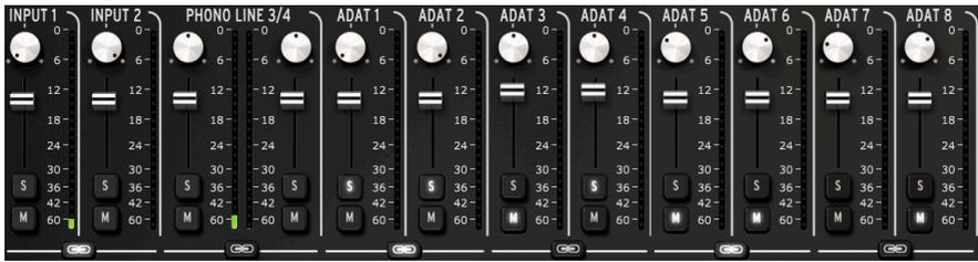
Quand l'Entrée Numérique est réglée sur ADAT et que la plus faible des deux fréquences d'échantillonnage est sélectionnée, huit canaux ADAT seront affichés.
