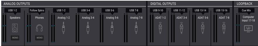
La zone des sorties s'étend de gauche à droite en bas de la fenêtre de l'AFCC. Elle affiche en un coup d'œil les signaux qui passent par l'AudioFuse 8Pre, ainsi que les sources et les niveaux montrés par les indicateurs à LED. Et selon le mode de fonctionnement (USB ou ADAT), il peut y avoir des menus qui vous permettent de sélectionner quelle source d'entrée sera routée à quelle sortie, une paire à la fois.
