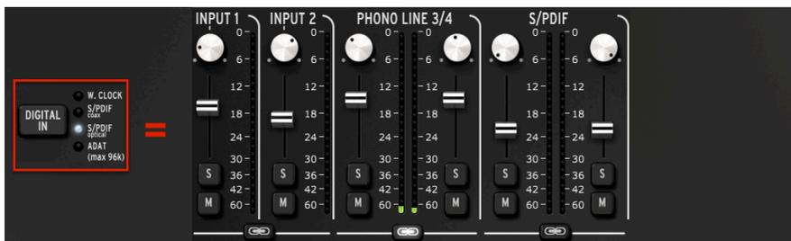
Une autre paire de canaux audio est ajoutée quand l'Entrée Numérique est réglée sur l'une des deux entrées S/PDIF (coaxiale ou optique). Toutes les fréquences d'échantillonnage entre 44100 et 192000 sont disponibles.
