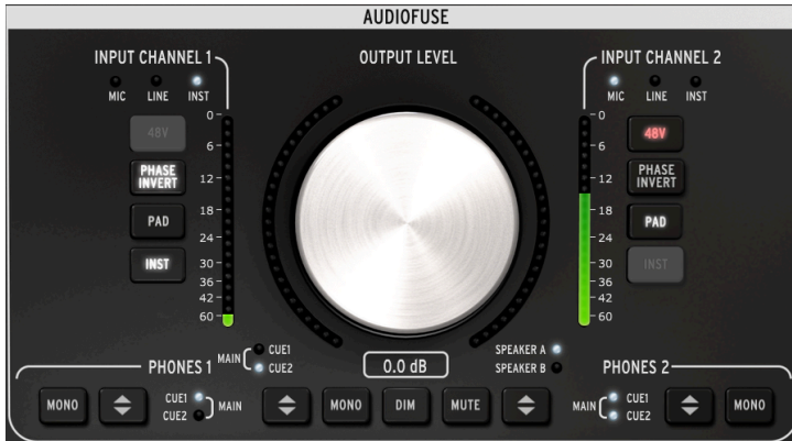
La partie entrée/sortie principale du Control Center
