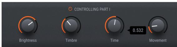
Pour ramener les contrôles à la présélection globale (mode bleu), il suffit de cliquer à nouveau dans le fond gris de la bande de la *Part*.
