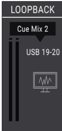
La sección Loopback proporciona dos canales de entrada de grabación adicionales a los que no se accede a través de los paneles frontal o posterior de AudioFuse Studio: los canales USB 19 y 20. Están conectados a un flujo de grabación USB dedicado, por lo que la salida de otra aplicación o de una de el mezclador de monitoreo de estudio AudioFuse puede ser grabada directamente por un DAW.
