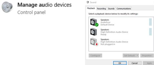
Aquí puedes configurar AudioFuse Studio para que sea tu dispositivo de grabación predeterminado, dispositivo de reproducción o ambos. Para hacerlo, selecciona la interfaz en las pestañas *Reproducción* y *Grabación* y presiona el botón *Establecer predeterminado*.
