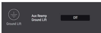
Este parámetro puede ser útil cuando se usa la función Re-Amp. Si escuchas un zumbido a tierra cuando AudioFuse Studio está conectado a un amplificador de guitarra, intenta configurar el parámetro Aux Out Ground Lift en encendido.
