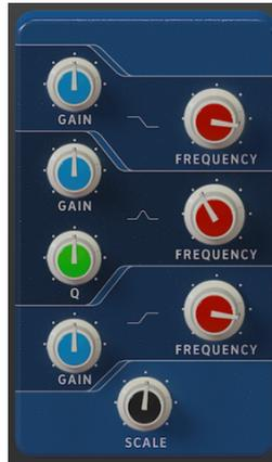
Un égaliseur est une banque de filtres où chaque filtre fonctionne dans une bande spécifique du spectre de fréquences, en augmentant ou réduisant ces fréquences pour modifier l'équilibre général du spectre. Il peut servir pour des réglages sonores subtils, ou pour accentuer certaines bandes et leur permettre de passer au travers du mix.
