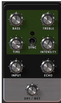
La pédale Tape Echo est une récréation d'un célèbre appareil d'écho à bande des années 1970 et 1980, qui fonctionnait en enregistrant des extraits de l'entrée audio sur bande magnétique, puis en les lisant avec un retard. En raison de la nature de la bande magnétique, un effet de saturation naturelle de la bande est transmis aux retards.
