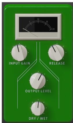
Le Limiter est un type de compresseur qui a une fonction bien précise. Il fonctionne essentiellement comme un « plafond » de volume pour empêcher le signal de dépasser un certain volume. Il est particulièrement utile en travaillant avec des sons qui ont une large plage dynamique et de nombreux effets qui pourraient potentiellement saturer le signal et provoquer des bruits parasites.
