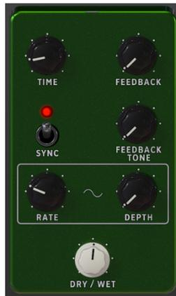
Analog Delay est un autre type de pédale de delay avec un son légèrement différent. Le principe est le même : l'audio d'entrée est enregistré et lu après un petit laps de temps. Un circuit de rétroaction introduit ensuite d'autres copies de l'audio retardé dans le signal d'origine.
