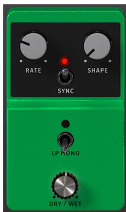
La pédale Stereo Pan peut servir à ajouter un mouvement stéréo au son. Elle se sert d'un LFO (low frequency oscillator - oscillateur basse fréquence) pour faire rebondir le son entre le canal gauche et droit pour créer une sensation de mouvement.
