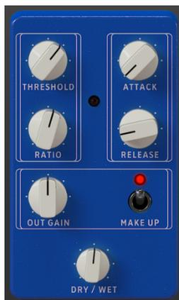
Un compresseur réduit le volume du signal audio au-dessus d'un seuil défini, qui a pour effet de lisser les différences de volume entre les parties bruyantes et silencieuses. En augmentant les parties plus silencieuses, il vous permet d'appliquer du gain supplémentaire au signal pour rendre les parties silencieuses plus bruyantes. Le compresseur est un outil très utile pour créer un son plus équilibré, qui se fond bien dans un mix.
