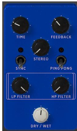
Delay ajoute de la dimension et de l'espace au signal, en créant des échos pouvant être répartis sur l'image stéréo. En utilisant des temps de retard plus longs, cela peut aussi ajouter une qualité rythmique au son, surtout en travaillant avec des sons qui ont une attaque plus prononcée.
