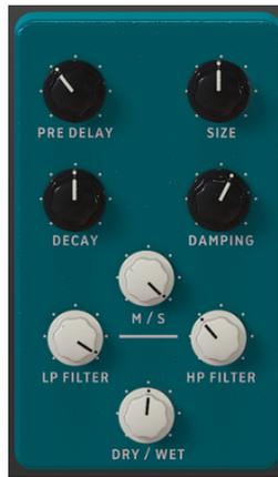
La pédale Reverb vous permet de placer le son dans un espace virtuel. Il s'agit d'une reverb algorithmique, contrairement au module Room à la fin de la chaîne d'effets qui est à convolution. Cependant, cette Reverb peut être placée n'importe où dans la chaîne du signal, afin que d'autres effets puissent être appliqués au son après avoir été traités par la reverb.
