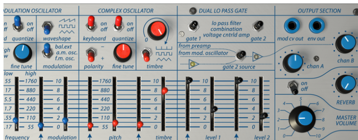
Beide Oszillatoren werden durch das Lo Pass Gate geroutet
