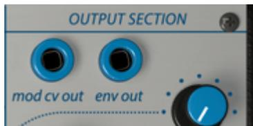
El "Env Out" no es una salida de voltaje de control adicional del generador de envolvente como podría pensarse, sino del rastreador de envolvente que es parte del preamplificador. Consulta [Pre-amplificador \[p.77\]](#) para obtener una explicación más detallada.
