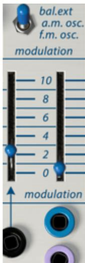
*El oscilador de modulación: control deslizante y el interruptor*
