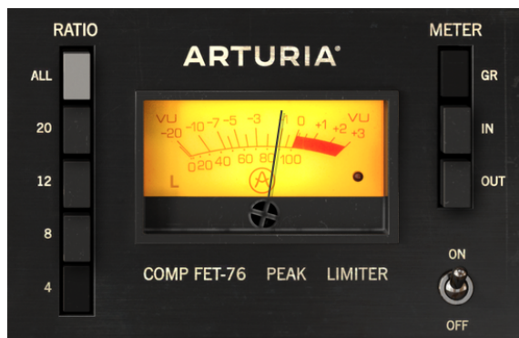
Medidor FET-76 VU comp, configurado para la reducción de ganancia. Observa la letra L en la esquina inferior izquierda y el indicador LED de recorte en la esquina inferior derecha.
