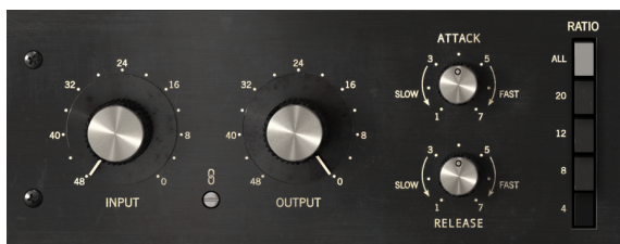
Los principales controles del compresor FET-76
