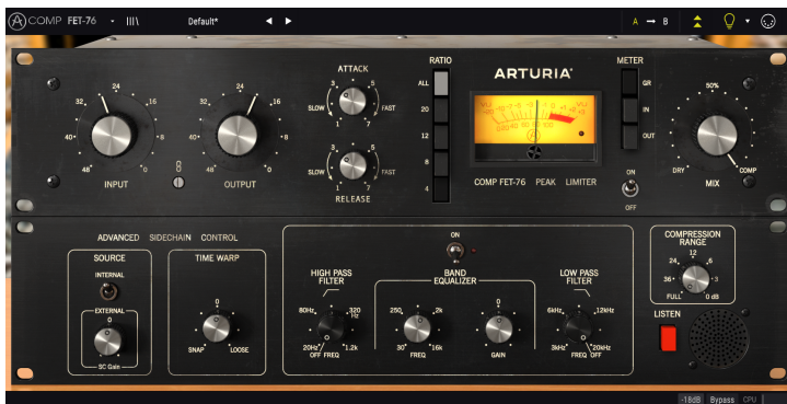
Der Comp FET-76 in einer Mono-Spur. Beachten Sie das Fehlen des Detection Mode-Reglers
