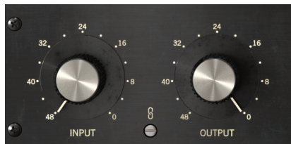
Comp FET-76 Input- und Output-Regler in den Standardeinstellungen. Der Link-Schalter befindet sich im unten zwischen den beiden Reglern
