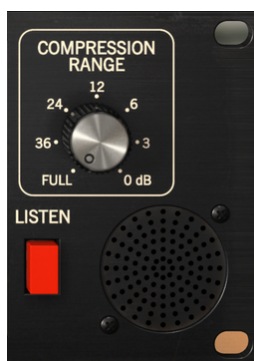
Control de rango de compresión completo y escucha del Comp FET-76
