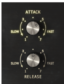
Controles de ataque y liberación del FET-76 en sus posiciones predeterminadas
