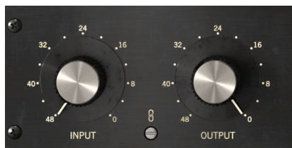
Controles de entrada y salida del Comp FET-76 en la posición predeterminada. Podemos ver el interruptor de enlace en la parte inferior, entre las dos perillas
