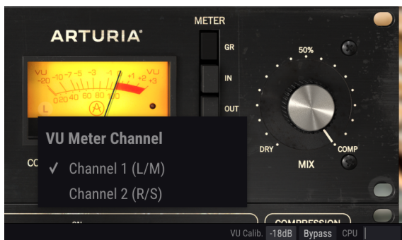
El Medidor VU, que muestra el selector de canales
