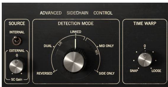
Sección de control de encadenamiento lateral avanzado del Comp FET-76 (como aparece en pistas estéreo)
