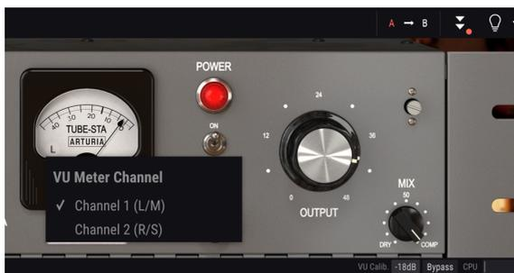
*VU-Meter-Kanalauswahl. In der unteren Symbolleiste sehen Sie die auf -18 dB eingestellte Kalibrierung*
