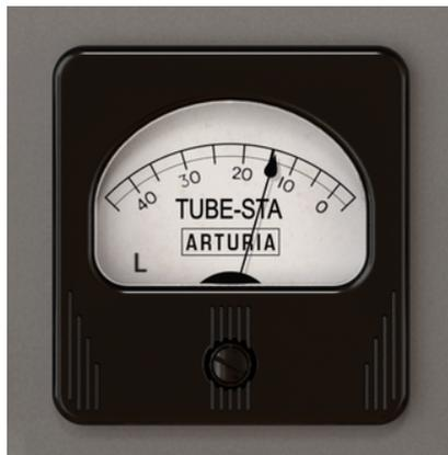
*Das Comp Tube-STA-Meter mit der Anzeige der Verstärkungsänderung. Beachten Sie den Buchstaben L in der unteren linken Ecke*
