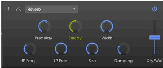
Ein Reverb-Effekt erzeugt eine sehr große Anzahl von Echos, die allmählich ausklingen. Das simuliert, wie das Eingangssignal in einem Raum oder Saal klingt.
