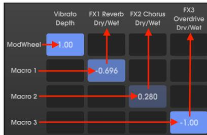
Im obigen Beispiel werden einzelne Quellen einzelnen Zielen zugeordnet. Sie können eine Quelle jedoch auch mehreren Zielen zuordnen oder ein Ziel von mehreren Quellen modulieren lassen, z.B. so:
