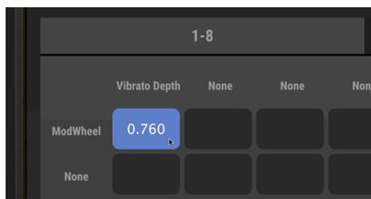
**i**!: Mod-Matrix-Intensitätspegel können positiv oder negativ sein. Positive Pegel erhöhen die DCW-Modulation, die Tonhöhe oder den Vibrato-Level, negative Werte verringern sie. Beachten Sie, dass die Farbe des Quadrats, das die Verbindung zwischen Quelle und Ziel darstellt mit einem höheren Pegel auch heller eingefärbt wird. Das gilt sowohl für die positive als auch für die negative Richtung.
