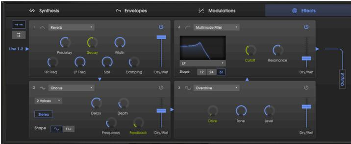
*Die Effects-Seite mit einer seriellen Verkettung von vier digitalen Effekten: Ein Reverb wird in einen Chorus geleitet, dieser in einen Overdrive dann in ein Multimode-Filter. Die blauen Pfeile zeigen den Signalfluss an. Die grünen Steuerelemente stehen als Modulationsziele in der Mod-Matrix zur Verfügung.*
