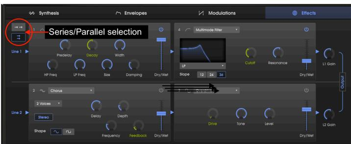
*Die gleichen Effektmodule wie in der ersten Abbildung, jedoch im Parallelmodus. Line 1 geht durch einen Reverb in einen Multimodefilter und Line 2 durch einen Chorus in einen Overdrive. Beachten Sie die zusätzlichen Lautstärkereger für Line 1 und Line 2 auf der rechten Seite.*
