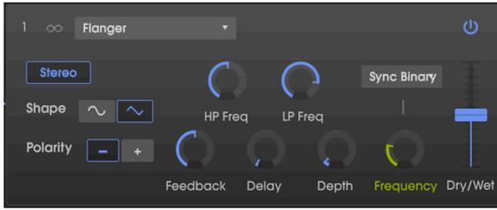
Ein Flanging-Effekt wird erzeugt, indem zwei identische Signale kombiniert werden. Dabei wird eines der Signale um einen kleinen Betrag verzögert und dessen Verzögerungszeit moduliert. Die rekombinierte Ausgabe erzeugt einen Ton, der durch die Harmonischen des ursprünglichen Signals nach oben und unten schwingt. Sie erhalten einen typischen "Kammfilter"-Effekt.
