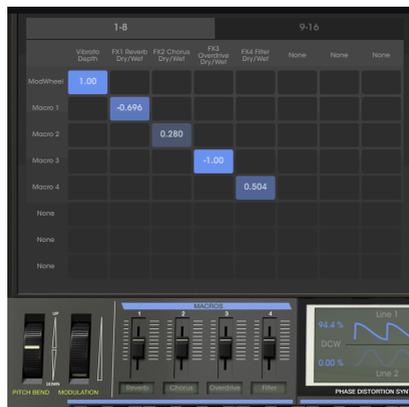
Die ausgewählten Modulationsquellen (Sources) sind auf der linken Seite aufgeführt (in der ersten Spalte), die ausgewählten Modulationsziele (Destinations) in der oberen Reihe (Spaltenüberschriften). Die blauen Kästchen zeigen die Verbindung und die Modulationsintensität (Amount) von einer Quelle zu einem Ziel.
