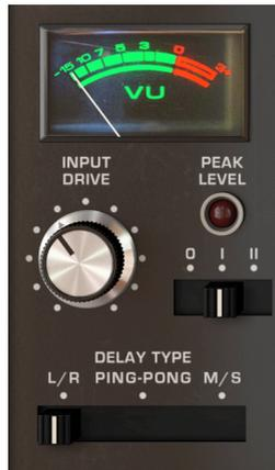
El medidor **VU** se puede usar para monitorear el nivel de la señal de entrada ajustada.
