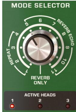
La perilla **Selector de Modo** especifica diferentes combinaciones de los 3 cabezales de reproducción y la reverberación que se utilizarán. Hay 12 configuraciones diferentes. Los ajustes 1-4 son solo eco de cinta, los ajustes 5-11 son una combinación de eco de cinta y reverberación, y el ajuste 0 es solo reverberación. Los LED de Cabezas Activas debajo de la perilla indican qué cabezales de reproducción están activos para el ajuste actual.
