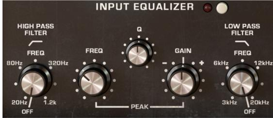
El Ecuilizador de Entrada es una función nueva que no estaba disponible en el hardware original. Esto le permite dar forma al sonido antes de que entre en la cámara de eco y el tanque de reverberación de resorte, lo que le permite acentuar o limitar las frecuencias del sonido que son procesadas por el eco y la reverberación. El Ecuilizador de Entrada cuenta con tres filtros: paso alto, paso bajo y pico.
