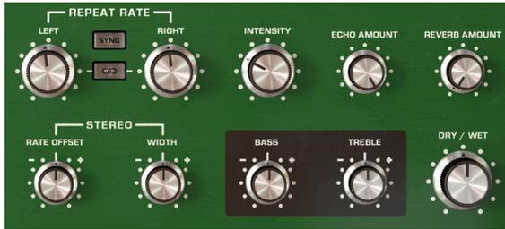
**Frecuencia de Repetición** varía la velocidad de la cinta, cambiando así el intervalo entre los ecos. La frecuencia de repetición para cada canal se puede configurar de forma independiente o enlazada.
