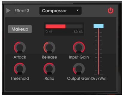
Un compresor es un control de nivel automático. Si una señal se eleva por encima de un cierto nivel (el umbral), el compresor reduce la salida de la señal para compensar (a relaciones bajas) o no deja que suba en absoluto (relaciones altas, también llamados "limitantes"). Generalmente se utiliza para ayudar a mantener un nivel de sonido constante, aunque hay muchas otras formas de utilizarlo.
