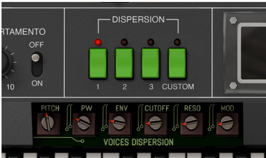
*La sección DISPERSION con la "cubierta" abierta. El preajuste de dispersión 1 muestra cierta variación de tono y niveles bajos de ancho de pulso, envolvente, corte y resonancia de VCF y dispersión de modulación*
