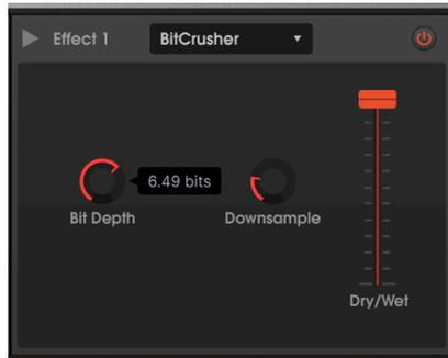
Este es un efecto de distorsión digital que opera reduciendo la longitud de la palabra (profundidad de bits) y disminuyendo la resolución de la señal digital, introduciendo ruido, aliasing y atenuando la respuesta de frecuencia. Esto es lo que sucede cuando los dígitos buenos se vuelven malos.
