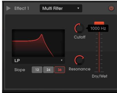
*En modo LP (filtro de paso bajo) con una pendiente de 36 dB/octava y una resonancia bastante alta*
