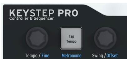
Le potentiomètre Tempo/Fine détermine le tempo de 30-240 battements par minute (BPM). À mesure que vous tournez ce potentiomètre, la valeur de BPM est automatiquement arrondie au nombre entier le plus proche et affichée sur l'écran OLED du KeyStep Pro. Maintenir SHIFT tout en tournant ce potentiomètre vous procure un contrôle plus fin sur le BPM en désactivant l'arrondi au nombre entier.
