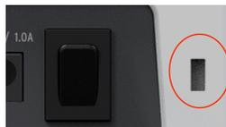
Nous avons placé un port de verrouillage Kensington à l'extrémité droite du panneau arrière de la machine afin de vous permettre de bien le fixer sur la surface de votre choix.
