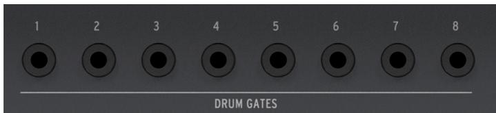
**i** : Ces signaux de gate ne sont pas limités au déclenchement de sons de batterie. Vous pouvez connecter ces sorties à n'importe quelle entrée qui accepte un signal gate ou de déclenchement, dont un générateur d'enveloppe ADSR ou une réinitialisation de LFO. Essayez, nous sommes sûrs que vous trouverez des utilisations rythmiques géniales !
