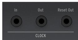
Le cycle ON de la sortie Clock (Clock Out) est de +5V, ce qui devrait être suffisant, même pour déclencher le plus insensible des modules Eurorack.
