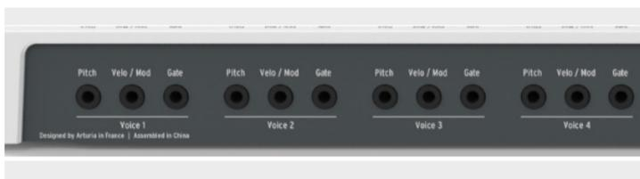
La sortie Pitch CV est surtout utilisée pour contrôler la hauteur d'un oscillateur externe contrôlé en tension (VCO).
