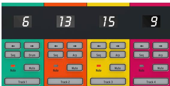
Les contrôles de piste sont identiques, sauf un bouton : Track 1 possède un bouton Drum pour le séquençage de batterie, mais les Tracks 2, 3 et 4 ont chacune un bouton Arp pour les arpégiateurs. Les contrôles de piste fonctionnent ainsi :
