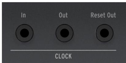
Le KeyStep Pro est capable d'envoyer et de recevoir des signaux de synchronisation. Il possède aussi une sortie Reset Out qui permet aux séquenceurs externes dotés d'une entrée Reset de se relancer au début d'une séquence quand une séquence du KeyStep est redémarrée.
