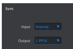
Ces réglages vous donnent la possibilité de spécifier les entrées qui recevront des signaux de tempo et de synchronisation, ainsi que les fréquences d'horloge d'entrée et de sortie. En modifiant ces réglages, vous déterminez quel type de signal d'horloge sera transmis par les connecteurs de sortie et reconnu par les entrées sync/clock.
