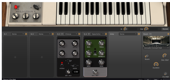
Page FX du Mellotron V, avec Chorus à l'emplacement fx 3, et Tape Echo à l'emplacement fx 4. Le contrôle Chorus Dry/Wet est en cours d'édition
