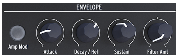
El generador de envolventes
