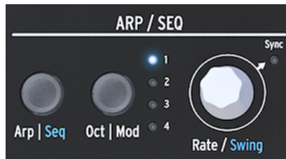
Der Arpeggiator und der Sequencer
