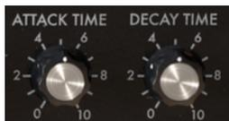
*Les potentiomètres unipolaires Attack Time et Decay Time*
