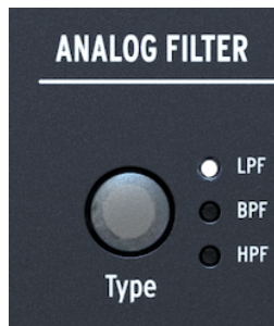
Der Type-Taster und dessen LEDs
