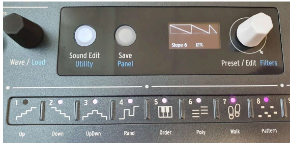
Ein Shaper-Pattern mit Segmenten unterschiedlicher Länge
