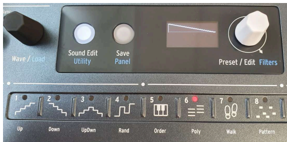
Einstellen des letzten Schritts des Shaper-Patterns
