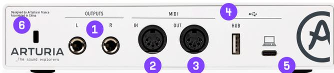
1. Sorties - ces sorties jack 1/4" symétriques peuvent être connectées directement à des enceintes actives ou à d'autres appareils tels que des amplificateurs et des mixeurs.
