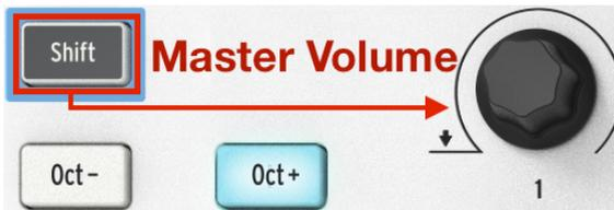
*Shift + encodeur 1 contrôlent le volume maître sur Analog Lab Lite.*
