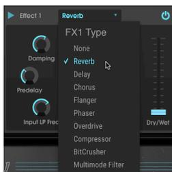
各エフェクトスロットにはWet/Dryスライダーがあり、原音（エフェクトがかかっていない音）とエフェクト音とのバランスを調節できます。このスライダーを完全にDry側にセットすると、そのエフェクトがバイパスになります。**Serial**と**Parallel**の矢印ボタン（画面左側）でエフェクトの接続をシリーズ（直列）またはパラレル（並列）に切り替えられます。シリーズ接続の場合、OB-Xa Vの出力が1つ目のエフェクトに入り、そこから2つ目のエフェクトに入っていきます。パラレル接続では、OB-Xa Vの出力が3つのエフェクトに分岐して同時に入り、各エフェクトの出力を最終段でミックスします。
