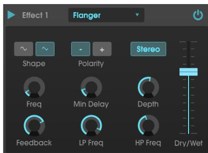
フランジャーは、FreqとDepthノブの設定次第で、穏やかな感じにも激しいフランジングにもなります。Depthを高めに設定すると、原音のピッチ自体が変化しているように聴かれますが、これはアナログフランジャーの回路動作を再現したために生じる効果です。
