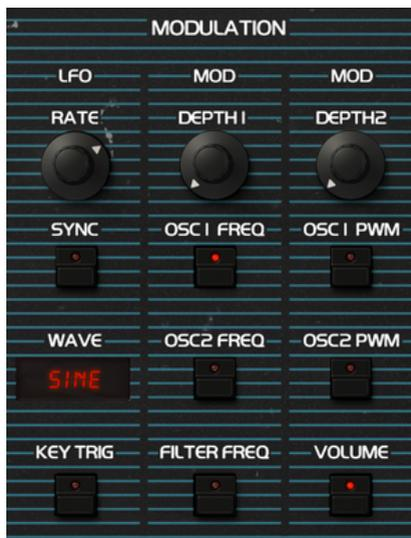
このセクションには、ローフリケンシーオシレーター (LFO) があります。LFOでOB-Xa Vのフィルターカットオフやオシレーターのピッチなどにモジュレーションをかけ、動きのあるサウンドを作ることができます。このモジュレーションセクションは、オリジナルのOB-Xaと同様、特定のパラメーターのサブセットに内部接続されています。また、[アドバンスパネル \[p.37\]](#)にはフレキシブルなモジュレーションエンベロープセクションもあり、OB-Xa Vのほとんどのパラメーターにモジュレーションをかけることができます。LFOがターゲットパラメーターにどのようにモジュレーションをかけるのか、そのイメージをつかむために、下図をご覧ください：
