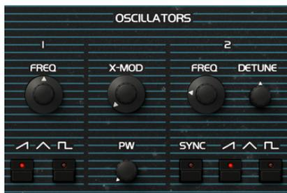
このセクションでは、サウンドの根幹部分を担うオシレーターの種類設定を行います。2つのオシレーターがあり、両方を使用してクロスモジュレーションをかけて複雑な音を作り出すことも可能です。クロスモジュレーションは、オリジナルのOB-Xには搭載されていましたが、後継機種OB-Xaでは削除されてしまった機能でした。OB-Xa Vではこの機能を復活され、さらにノブで連続可変できるように改良しました (OB-Xではオン/オフスイッチのみでした)。
