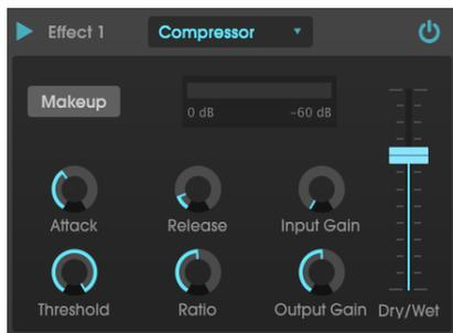
コンプレッサーをエフェクトチェーンに入れると、入力時のアタックの歪みを解消した状態で次のエフェクトへ信号を送れます。また、原音は比較的早く減衰するタイプの音の場合は、ロングサステインにする効果もあります。ドラムでは音の迫力を出すためにコンプレッサーがよく使われます。また、放送局でもオーディオレベルの均一化にコンプレッサーがよく使われています。
