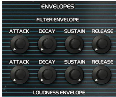
このセクションにはエンベロープの各種コントロールがあります。エンベロープは、音の時間的な変化を作るセクションです。このセクションにはエンベロープが2つあり、1つはラウドネスエンベロープ、つまり音量をエンベロープジェネレーターでコントロールします。もう1つはフィルターのカットオフフリケンシーをコントロールするフィルターエンベロープです。
