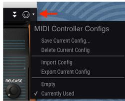
ツールバーの右端にある小さな矢印アイコンをクリックすると、OB-Xa VをコントロールするMIDIマッピングの管理メニューが開きます。例えば、複数のフィジカルコントローラー（ライブではコンパクトなキーボード、レコーディングではフルサイズのキーボード、パッドコントローラー等）をご使用の場合、各コントローラー用のMIDIマッピングセットを設定しておき、それを瞬時にロードできます。MIDIコントローラーをチェンジした時に、MIDIマッピングを最初からやり直す必要がなく、非常に便利です。
