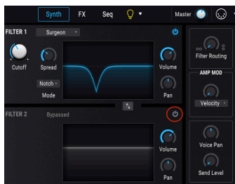
Filter 2 befindet sich im Bypass-Modus
