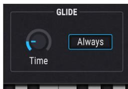
Cuando la función Glissando está activa, el tono cambiará gradualmente entre dos notas tocadas. Para agregar Glissando a tu preajuste, gira la perilla de Tiempo de Glissando a un número superior a 0.00. Los valores van desde 0.001 a 10.0 segundos.
