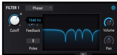
Ce filtre s'inspire d'un effet omniprésent dans la musique pop depuis les années 60 ; Similaire à un filtre Comb dans la mesure où il utilise une série de pics harmoniques et de notches pour traiter le signal d'entrée, généralement modulé avec un LFO par la suite. Le phaser permet également de définir le nombre de pics (Poles) utilisés.
