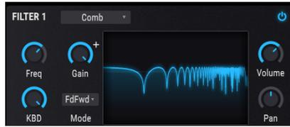
On obtient un un filtre en peigne en ajoutant au signal d'entrée une version retardée de lui-même, ce qui résulte en une série d'harmoniques renforcées et annulées.
