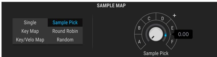
*Sample Pick Map, avec les emplacements d'échantillons pleins et mod + visibles*
