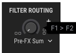
Les filtres 1 et 2 peuvent être reliés en série, ce qui signifie que la sortie du filtre 1 est acheminée directement vers l'entrée du filtre 2. Ce processus permet un filtrage extrêmement précis du signal.
