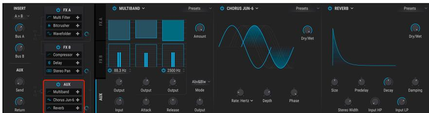
L'onglet FX Aux possède trois modules identiques à ceux des bus A et B. Le bus FX Aux a donc autant d'atouts dans sa manche que les bus A et B.
