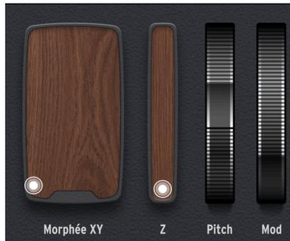
Hierbei handelt es sich einfach um "Spiegelbilder" der Performance-Controller des PolyBrute. Von links nach rechts finden Sie das Morphée XY-Pad, den Morphée Z-Strip, das Pitch-Bend-Rad und das Modulationsrad.
