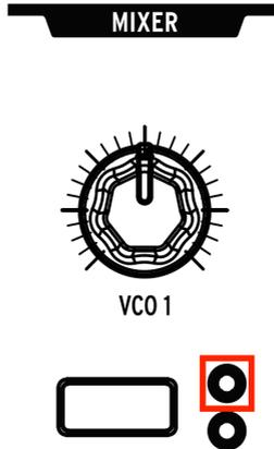
En la sección del Mezclador, presiona el botón de Filtro VCO 1 varias veces hasta que se encienda el LED dentro del círculo naranja. Las secciones del filtro están codificadas por colores para que coincidan con los círculos, por lo que esto significa que VCO 1 se enruta al filtro Steiner.
