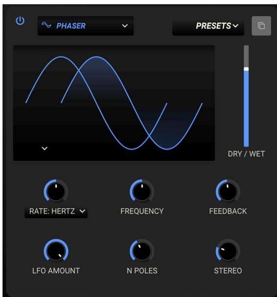
アナログのストリングマシンやいわゆる「ヨットロック」で聴かれるエレピの特徴的な「シュワシュワ/ジョワジョワ」サウンドは、入力信号の位相を変化させた音と入力信号をミックスして位相の干渉によるコムフィルター効果を作り出し、その帯域を変化させることで独特のスウィープサウンドを作り出します。それが、フェイザーというエフェクトです。
