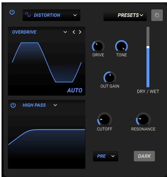
Prophet-VS Vのディストーションは、従来のファズボックス的ディストーションの粋を大きく超え、ソフト/ハードクリッピングやテールサチュレーション、その他トラディショナルなものとは異なる波形加工手法などを含む、全15種類のアルゴリズムを内蔵しています。全タイプともぜひお試しください！
