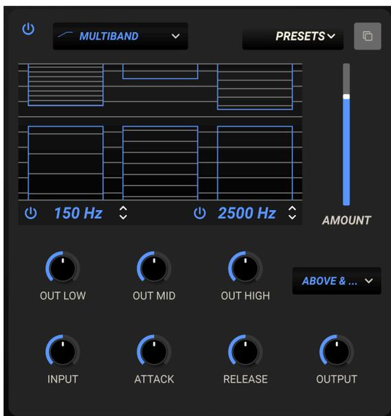
Prophet-VS V のマルチバンドコンプレッサーは、最大3つの周波数帯域で個別にコンプレッション/エクスパンションをかけることができます。また、2つのバンドのオン/オフを切り替えることも可能です(2つのバンドをオフにした場合は、1バンド (フルレンジ) のコンプレッサー/エクスパンダーとして機能します)。上図のディスプレイ部にある6つの四角のうち下側の3つはエクスパンダーで、コンプレッサーとは逆の動作、つまり小さい音をより小さくし、ダイナミックレンジを伸長する方向に作用します。
