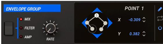
このエンベロープでは、最大5個の ブレイクポイント (ジョイスティックが進む方向が変わるポイント) を使用できます。その中の、2点間を結ぶ線が「ベクターシンセシス」のベクトルです。打鍵するとディスプレイ内の「バック」が移動して、ミックスエンベロープの現在位置をリアルタイムで表示します。
