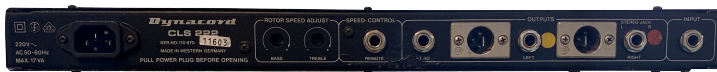
Los controles de velocidad estaban empotrados en el panel trasero, y se incluían salidas XLR y de 1/4 de pulgada.
