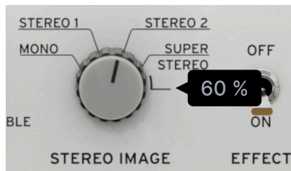
Le potentiomètre Stereo Image du CLS-222 physique était un interrupteur à quatre positions. Celui d'Arturia est continu.
