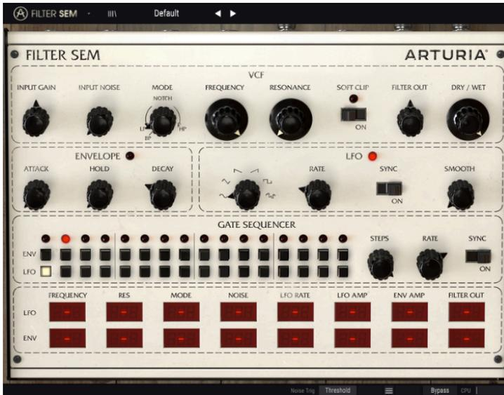
*Filter SEM avec tous les contrôles en position Init*
