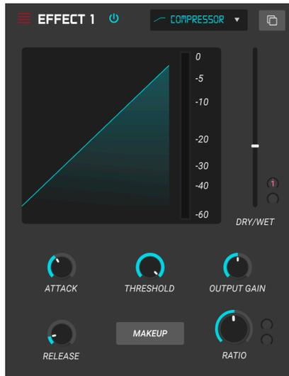
Wenn Sie zum Beispiel Effektketten verwenden, kann der Kompressor verhindern, dass die Attack-Transienten eines Sounds den Eingang des nächsten Effekts übersteuern. Er kann auch einen Klang pegelmässig unterstützen, der schnell abfällt. Schlagzeug wird oft komprimiert, um mehr "Punch" hinzuzufügen. Komprimierung wird auch bei Radio- und Fernseh-Audiosignalen hinzugefügt, um diese innerhalb eines bestimmten Lautstärkebereichs zu halten.
