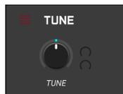
Dieser sehr einfache Bereich regelt die Gesamtstimmung des SQ80 V. Normalerweise lassen Sie diesen Parameter auf 440 Hz eingestellt, aber Sie können die Stimmung bis auf 400 Hz absenken und bis auf 480 Hz anheben. Es gibt nur einen Haupt-Regler:
