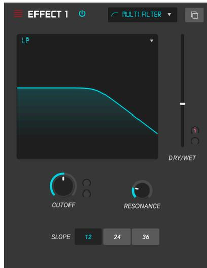
Das Multimode-Filter ist ein leistungsstarkes Klangformungsfilter, das eine zusätzliche Möglichkeit bietet, Frequenzen im Ausgangsbereich zu formen. Sie können alternativ auch in die Filtergrafik klicken und ziehen, um Cutoff und Resonanz anzupassen.
