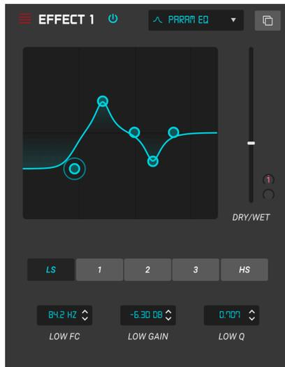
Der SQ80 V bietet einen vollparametrischen Fünfband-Equalizer. Ein Equalizer (EQ) verstärkt oder dämpft selektive Frequenzen im Frequenzspektrum. Mit einem parametrischen EQ können Sie den Bereich einstellen, der von den Frequenzbändern (d.h. Q oder Filtergüte) beeinflusst wird.
