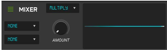
Dies ist ein interessanter und sehr praktischer Modulationsmischer. Er bietet zwei Eingänge, denen Sie Modulationsquellen zuweisen können sowie eine Reihe von Operatoren, um diese beiden Quellensignale unterschiedlich zu kombinieren. Es gibt auch einen Waveform-Visualizer, in dem Sie die Auswirkung des Operators auf die Modulationsquellen auf sehr intuitive Weise sehen können. Es gibt vier Bedienelemente:
