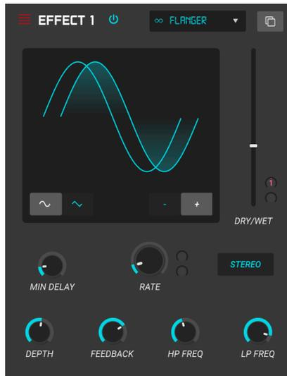
Flanging kann sowohl subtile als auch extreme Effekte erzeugen, abhängig von der Geschwindigkeit und der Intensität der Modulation. Bei höheren Depth-Einstellungen hören Sie eine Änderung der Tonhöhe. So funktionieren die Schaltungen in einem analogen Flanger und wir haben darauf geachtet, dieses Verhalten in unserer Software nachzubilden.
