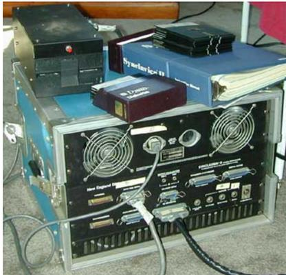
*Processeur Synclavier II avec Disquettes 5.25"*
